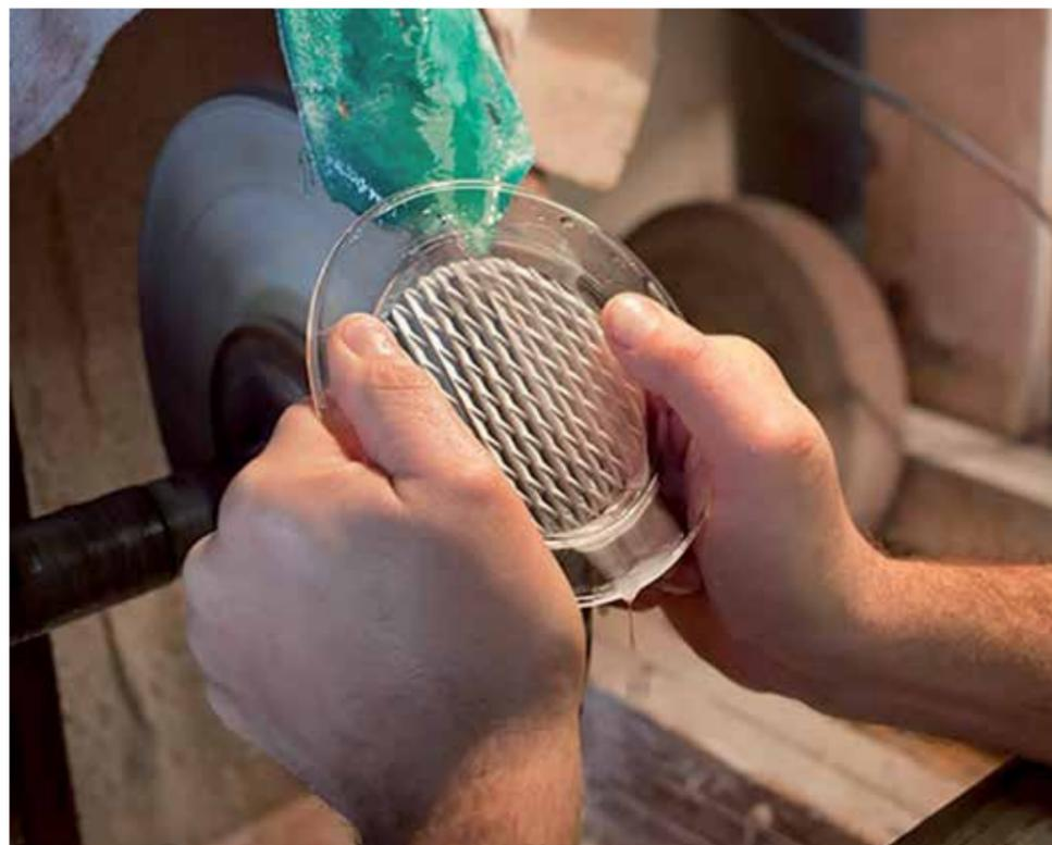
rimasti invariati ad esclusione dell'alimentazione elettrica in sostituzione del tradizionale pedale, tanto da valersi con ormai collaudata dimestichezza delle mole, sia che traccino un sottile segno o che segnino in profondità la superficie dei cristalli soffiati.
