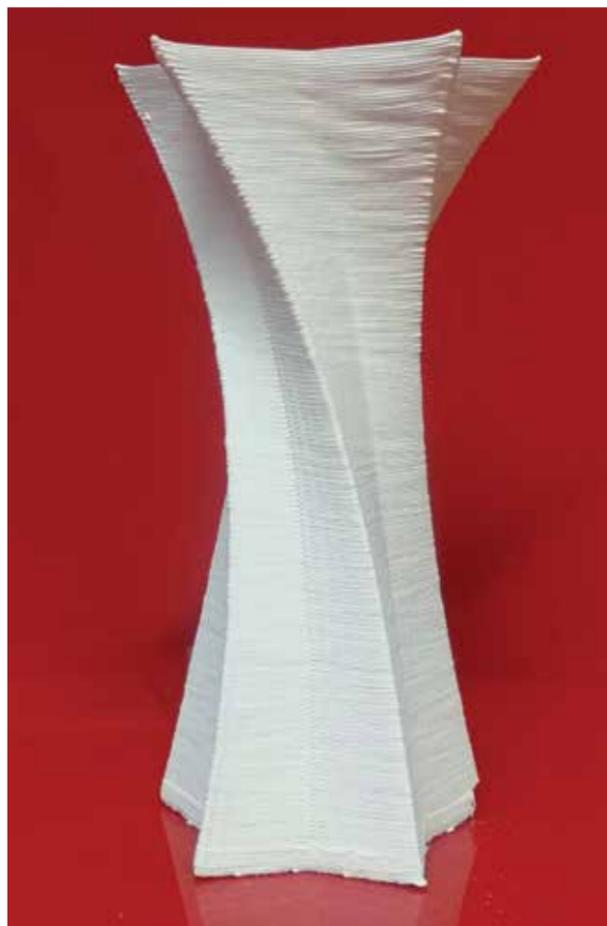
■ Prototipo in ceramica stampato con DeltaWASP FDM 3D printer. FabLab Viterbo. Foto S. Valentini
